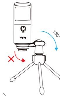
4. Используйте металлическое кольцо с резьбой, чтобы отрегулировать поворот микрофона.
