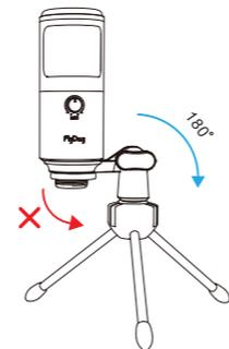
4. Використовуйте металеве кільце із різьбою, щоб відрегулювати поворот мікрофона.
