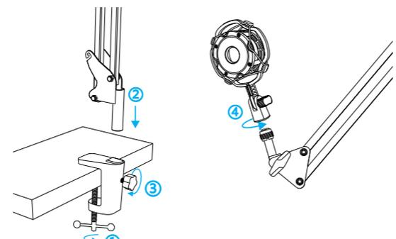
1. Закрутіть нижню частину С-подібного затискача до упору.
