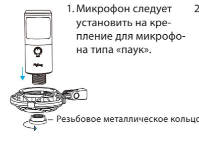
1. Микрофон следует установить на крепление для микрофона типа «паук».
