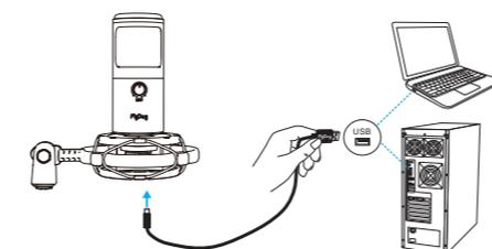
5. Підключіть роз'єм мікрофона до порту USB на задній панелі комп'ютера.
