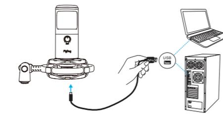
5. Подключите разъем микрофона к USB-порту на задней панели компьютера.
