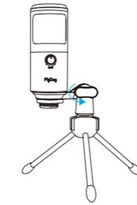
3. Наклоняйте микрофон только по часовой стрелке. Наклон микрофона против часовой стрелки может повредить шарнирное крепление.
